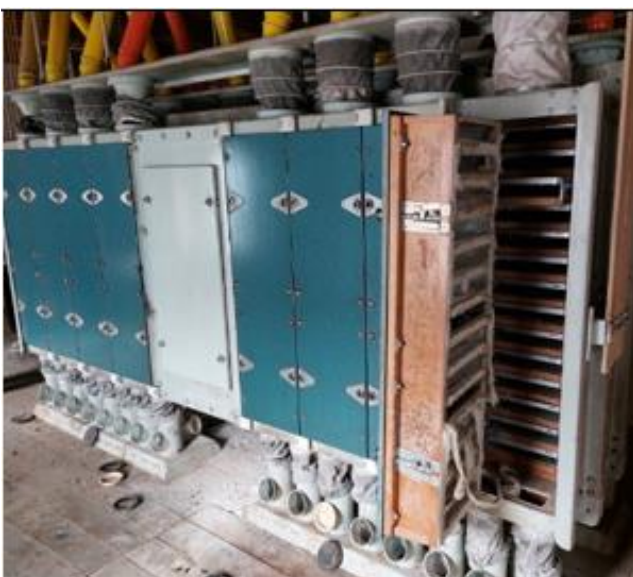
Der Plansichter trennt das vermahlte Korn in Mehle unterschiedlicher Dichte (Mineralstoffgehalt).
