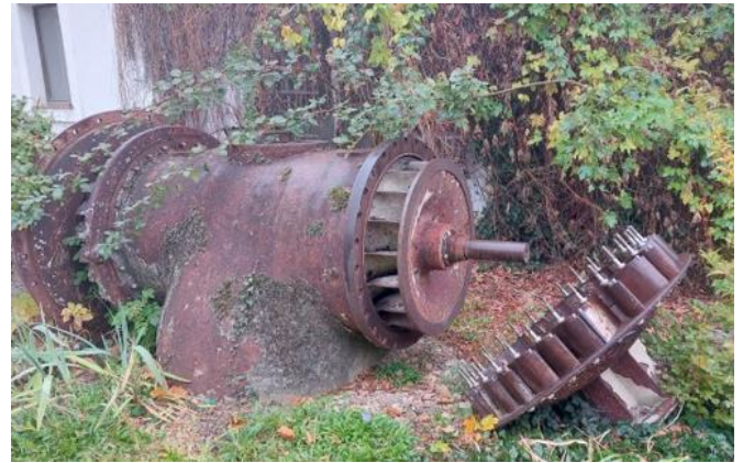
Francisturbine, Schaustück im Innenhof des Eingangsbereiches
