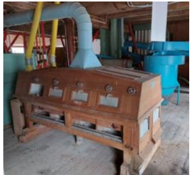
Die Gießputzmaschine trennt den Gieß in Größenklassen. Vergleich: Mehl < 150, Dunst 150-300, Gieß 300-1000 µm
